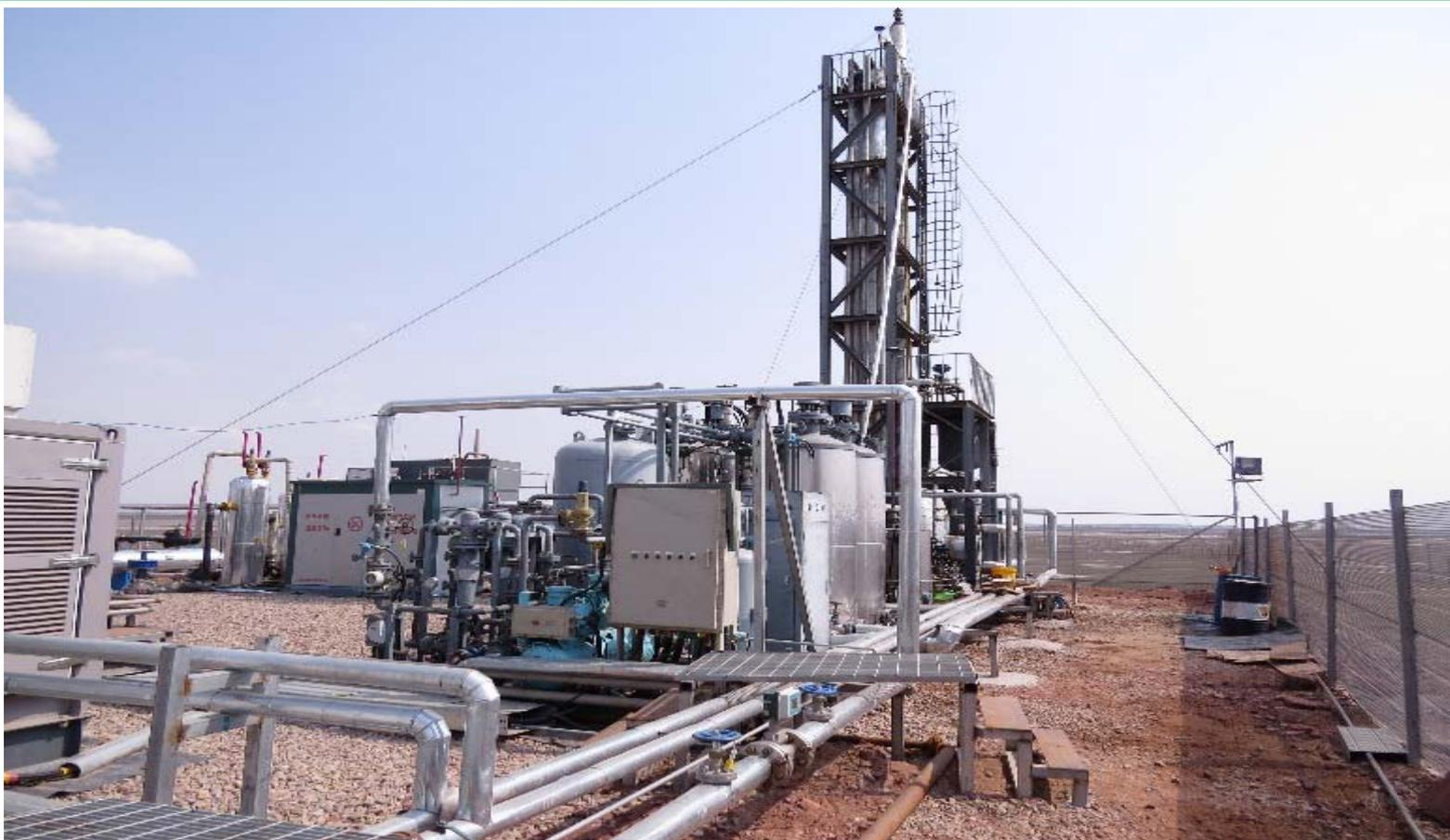
▶ 华北油气分公司对新投井、边远井产气进行了分类回收。具备进站条件的新井试气由放空燃烧改为进站试气，边缘井、地面配套不完善气田、区块新井试气尽可能进行CNG或LNG回收，累计回收天然气超过5550万方。
