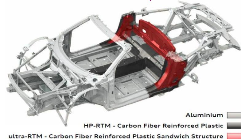
拉压工艺 (PuI Press) 制作的三明治结构复合材料
